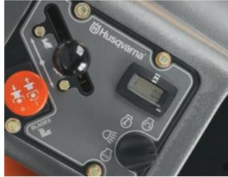
El medidor digital indica las horas de trabajo del tractor, característica útil para conocer el tiempo indicado de mantenimiento lo que permitirá alargar la vida útil y mantener siempre el desempeño óptimo.
