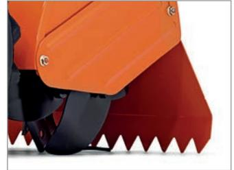
El sistema de cuchillas contra rotativas (giro en sentido inverso) facilitan la fractura del suelo haciendo más eficiente el trabajo.
