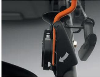
El clutch de freno de cuchillas BBC permite detener las cuchillas mientras el motor está en funcionamiento, característica útil cuando el usuario desea cruzar un sendero de grava o necesita vaciar la bolsa de recolección sin necesidad de apagar el motor.
