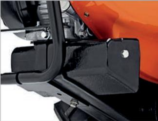
Los contrapesos incrementan el peso del equipo aumentando la carga ejercida sobre las llantas proporcionando un mejor balance y seguridad durante trabajos en terrenos densos o lodosos.
