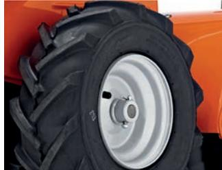
Las llantas fueron diseñadas para evitar contratiempos y facilitar el acceso a cualquier lugar, cuentan con un diámetro de 16" y huellas profundas que la facilitan el manejo y operación de estos equipos.
