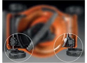
El sistema de tracción en las 4 ruedas proporciona al operador un excelente control, balance y posibilidad de trabajo en terrenos complicados.
