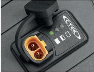
Esta característica proporciona una indicación clara del estado de la batería, lo que facilita la identificación de las necesidades de recarga, cuenta además con un puerto de conexión para el cargador de baterías Husqvarna.
